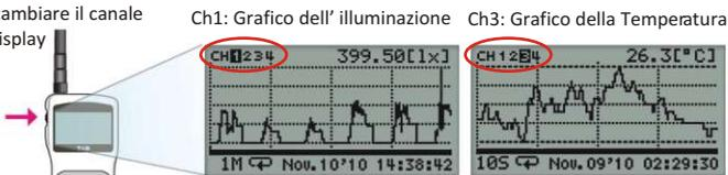
Attraverso il grafico è possibile verificare se i limiti impostati sono stati oltrepassati, oppure controllare quali sono stati i valori max e min o ancora fare lo zoom di una parte del grafico che si desidera verificare con più accuratezza.
