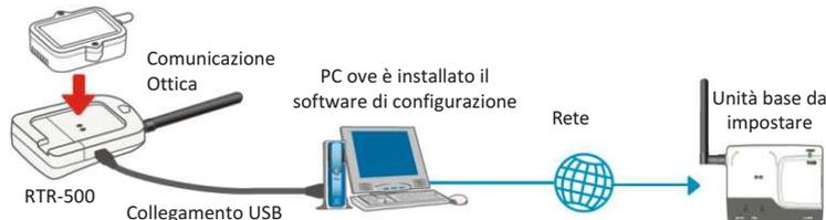
**Nota:** \*Se si vuole aggiungere una unità remota RTR-501 / 502 / 503 / 505 utilizzando la rete LAN è necessario disporre di una unità base RTR-500 collegata al PC via USB.
