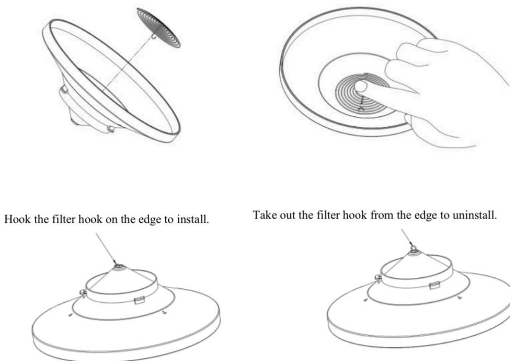
**Figura 12: Schema di installazione / disinstallazione del filtro del pluviometro**
