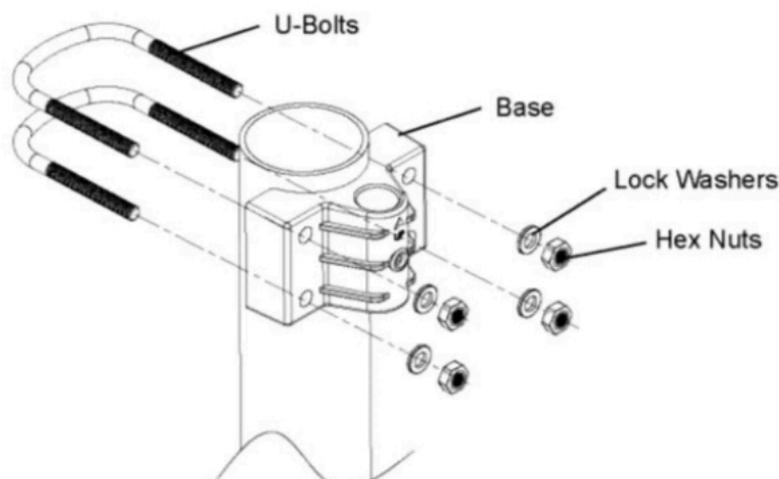
Installare ciascun dado M6 nell'ordine 1,2,3 e poi 4. Non serrare con un avvitatore a percussione, serrare a mano, quindi mezzo giro/180° Non di più. Se il tuo palo di montaggio è un materiale morbido (legno, pvc, ecc.) potresti dover serrare nuovamente i dadi M6 quando esegui la manutenzione ogni 3 mesi.
