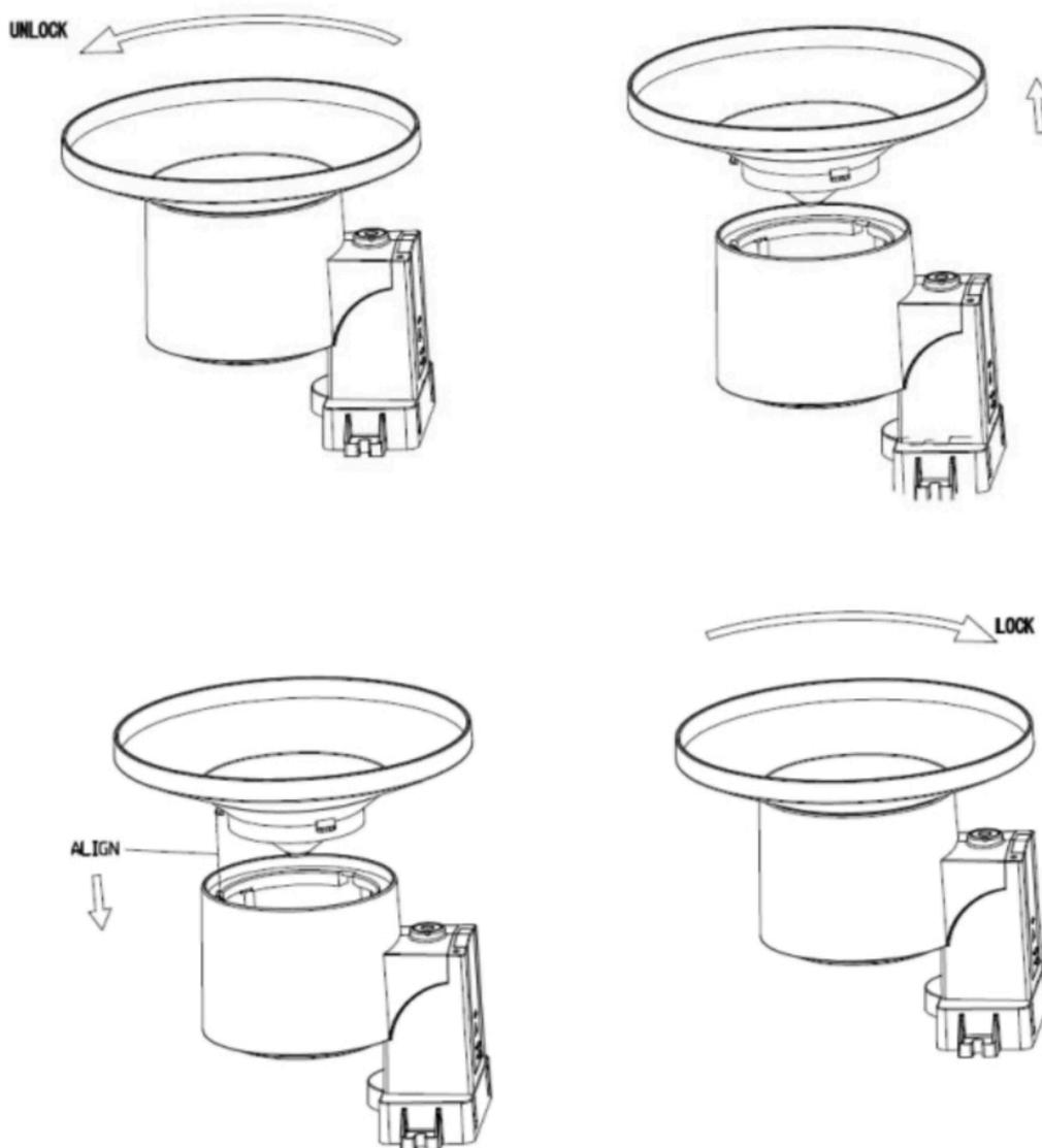
Figura 5: Manutenzione del pluviometro
