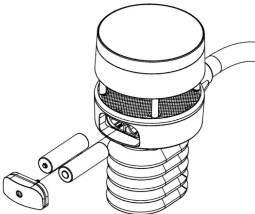
**Figura 5: schema di installazione della batteria**
