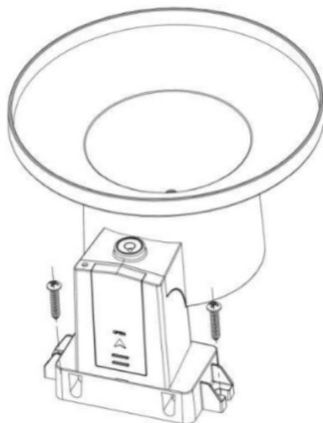
**Figura 16: schema di installazione del sensore del pluviometro con viti**
