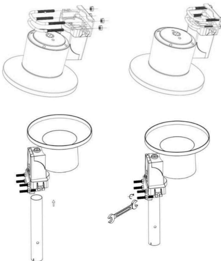
**Figura 15: installazione del pluviometro con bulloni a U**
